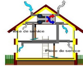
Schéma de principe d'un système de ventilation mécanique double flux par extraction avec balayage et échangeur de chaleur. Fenêtres fermées.
